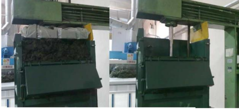
Şekil 7. Kapak siviçi bulunmayan, kapağı açıkken çalışan güvensiz bir pres.
