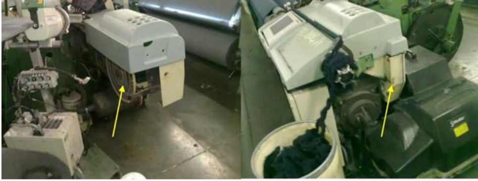
Şekil 9. Koruyucusu bulunan ve bulunmayan dokuma makinası rapiyer kasmağı
