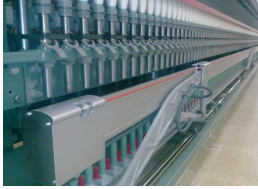
Şekil 5. Vatter makinası Acil Stop Gergi Teli
