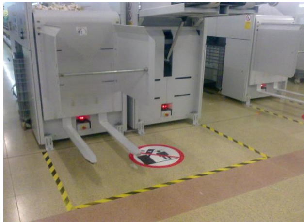
Şekil 6. Bobin makinalarında kasaların risk oluşturduğu alanların uygun şekilde işaretlenmesi.
